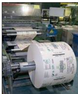
Цех резки бумаги на офисные форматы. Автоматическая резка, упаковка в пачки и коробки, палетизация
