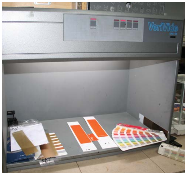
Световая кабина используется в лаборатории для субъективной оценки цветового различия оттисков
