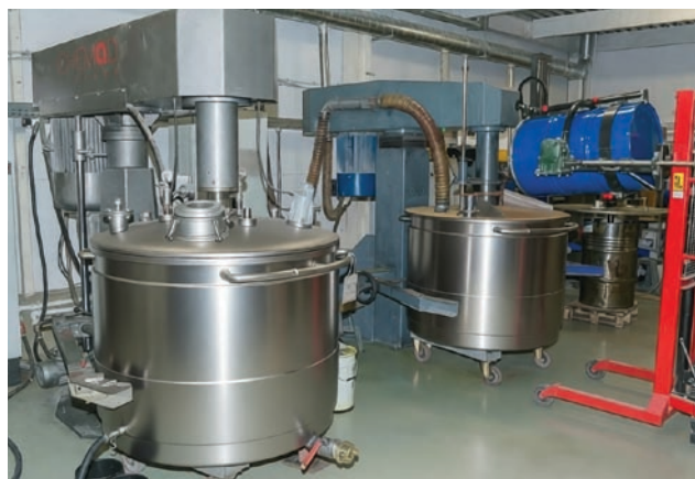
Миксеры для изготовления лаков (слева) и миксеры для изготовления флексографских красок (справа)
