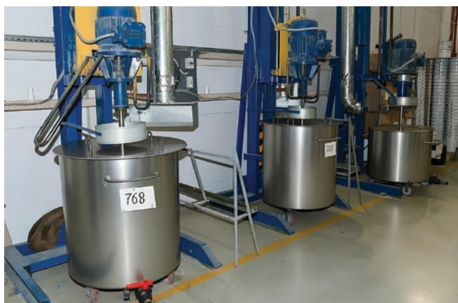
Миксеры для изготовления лаков (слева) и миксеры для изготовления флексографских красок (справа)
