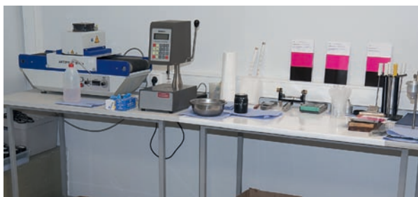
В лаборатории завода все лаки и краски проходят контроль на соответствие требованиям, а образцы из каждой партии хранятся на случай рекламаций
