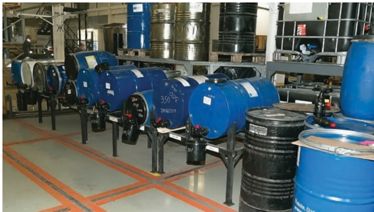
Большие цифровые дозирочные весы (слева) и емкости для хранения и дозирования компонентов красок и лаков
