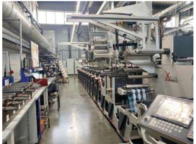
Парк печатного оборудования типографии состоит из флексографских машин Mark Andy (вверху) и Omet (внизу)
